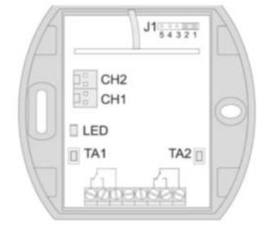
Betriebsart: Totmann-Steuerung (jedes Relais schaltet so lange, wie die entsprechende Taste gedrückt wird (max. 36s)
