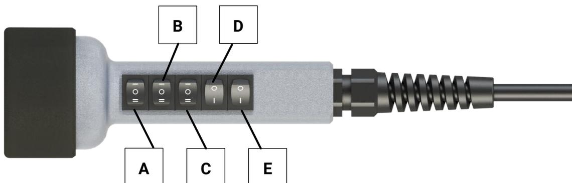
**A / B** Mouvement des plaques de test
