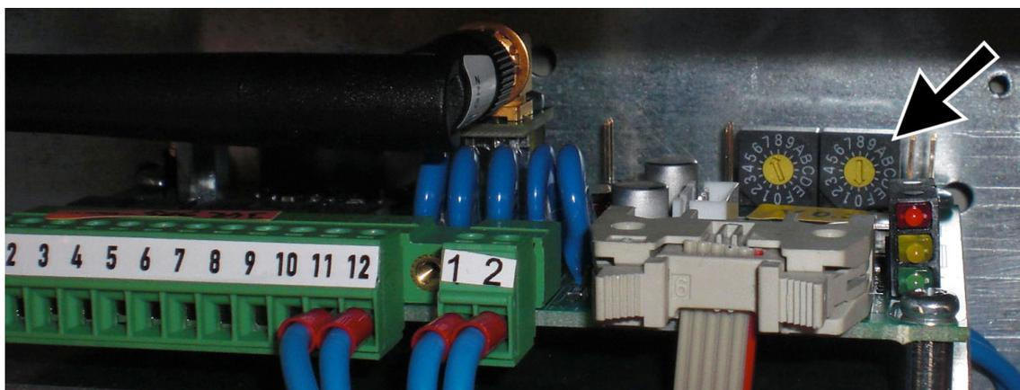
Le canal peut être réglé à l'aide de l'interrupteur rotatif de codage **de droite** sur la carte de commande.
