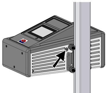
Zur Aufzeichnung dieser Daten ist ein USB-Stick erforderlich, der in die USB-A-Buchse außen am Gehäuse eingesteckt wird.
