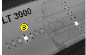
Die optionale Einheit ist im Fenstergehäuse (A) über der Fresnel-Linse eingebaut. Die zum Fahrzeug gerichtete Anzeige zeigt mit den farbigen LEDs (B) die Einstellrichtung.
