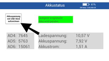
Die aufgezeichneten Daten des Akkustatus ermöglichen eine optimale Analyse in Problemfällen.
