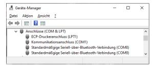
Geräte-Manager öffnen und unter "Anschlüsse (COM & LPT)" die COM-Schnittstelle für die Bluetooth-Verbindung prüfen.
