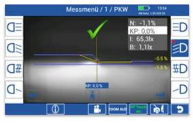
Durch Berührung des Touch-Displays im Bereich des Lichtabbilds kann der Knickpunkt gesetzt werden.
