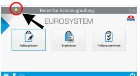
EUROSYSTEM-Anbindung: Steht eine Verbindung zum SEP, leuchtet die gelbe Anzeigelampe. In der Infoleiste am SEP erscheint ein Bluetooth-Symbol.
