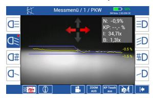
Wird der Knickpunkt falsch oder nicht erkannt (rote Pfeile nach links **und** rechts), kann der Knickpunkt manuell gesetzt werden.
